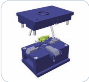
Apertura de un molde en Pro/ENGINEER Tool Design (cortesía de Adept)
