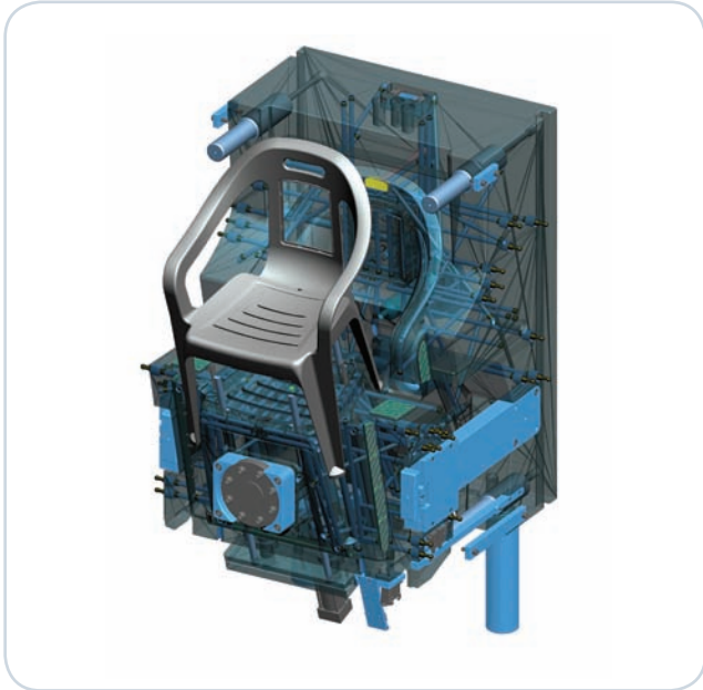
Conjunto de molde en Pro/ENGINEER Tool Design (cortesía de Moldopolástico, SA)
